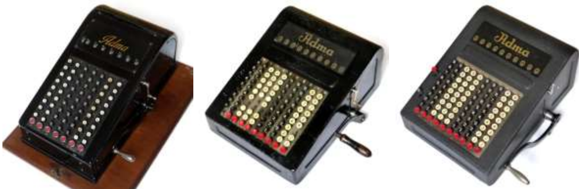
Abb. 24: Die beiden nichtdruckenden Adma -Varianten 47 : links wie BORDT ohne Druckwerk (Mannheim); die beiden Expl. rechts (Mannheim/Leipzig) wie Beschreibung in v. Schack 1914 S.148f und Martin S. 321
