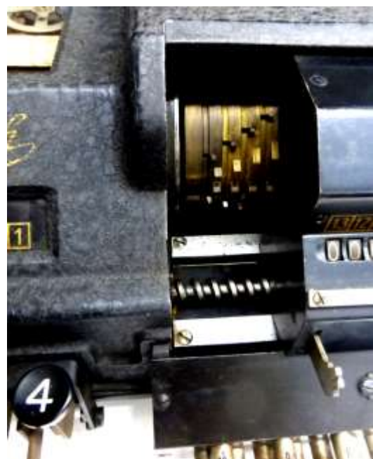
Abb. 31c: Summographe - Blick auf die Sprossenräder und auf die Schnecke für den Schlittentransport
