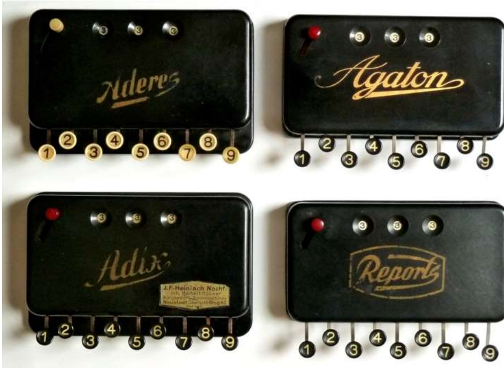
Abb. 18a: Beispiele für Adix -Modelle im Bakelitgehäuse mit unterschiedlichen Namen - beachte die Unterschiede in den Gehäuseformen links und rechts
