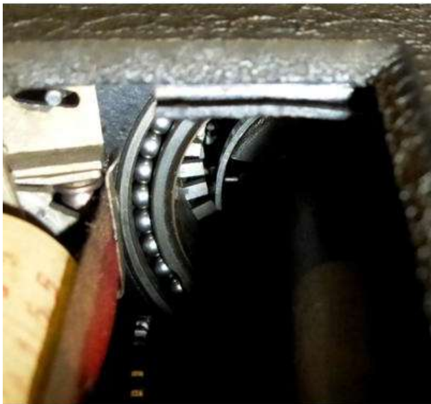
Abb. 31b: „Schlagkörper“ (Bildmitte), der je nach Tastendruck die entspr. Anzahl der links daneben sichtbaren Sprossen nach außen schiebt. Gut zu erkennen auch die kugelgelagerte Sprossenrad-Einheit und links unten das Druckpapier.
